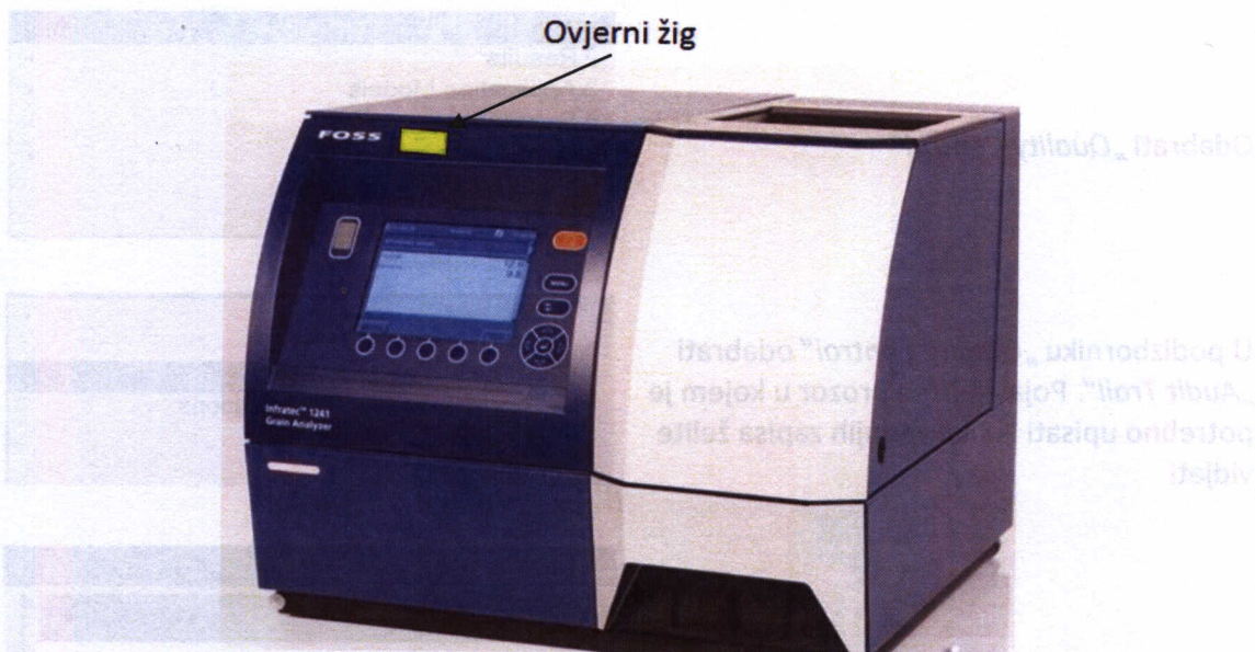
Slika 6. Infratec™ 1241; mjesto za postavljanje ovjernog žiga u obliku naljepnice
